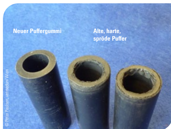
Abb. 10: Alte Gummipuffer müssen ausgetauscht werden
