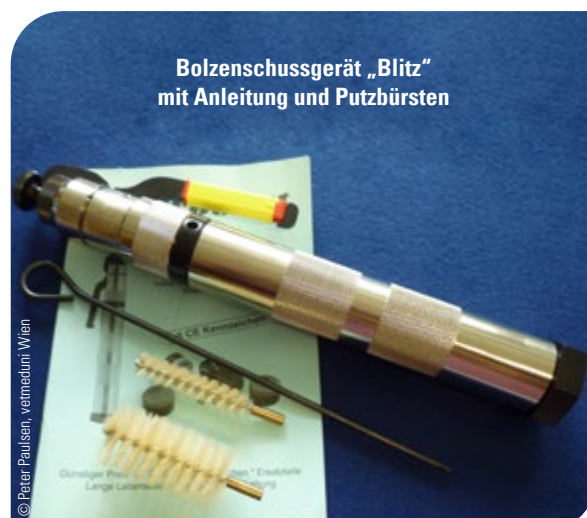
Abb. 6: Bolzenschussgerät Bauart „Blitz“ in ordentlichem Wartungszustand
